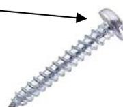
3 Parafusos P Z 2 de 4,2 x 45 mm de aço galvanizado autorroscante. É utilizado quando a ripa ou a régua é **de metal** e para prender o painel da telha, o angular e as tampas antipássaros à ripa ou régua de metal.
